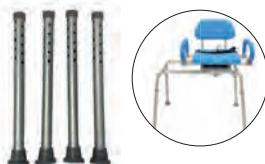
Set di gambe extra da quattro unità per utilizzare la panca TRANSFER su *vasche da bagno con altezza del bordo fino a 55 cm*. Con indicatore di lunghezza: sono regolabili in dieci differenti altezze per un range totale di circa 11,5 cm. Il puntale di appoggio è rivestito in gomma antiscivolo.
